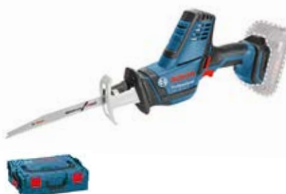
TIGERSÅG GSA 18 V-LI KOMPACT SOLO L-BOXX Kompakt, 21 mm. slaglängd, 3050 slag/min, bara 2,5 kg, L-BOXX. Art. nr. 0 601 6A5 001
