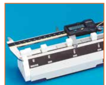
Kontroll av skjutmåttets noggrannhet (utvändig mätning)
