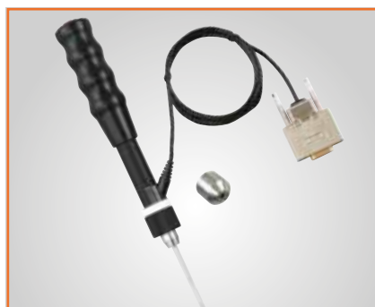
HLDL slagkropp UD-413 Används för konkava arbetsstycken som kugghjul, kullager etc.
