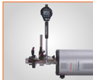
Kalibrering av hållindikator med tillbehörssats (typ C)
