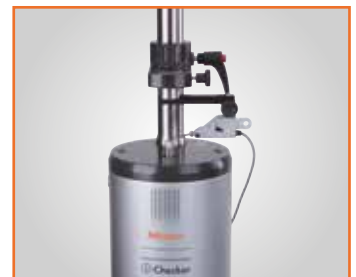
Kontroll av ledad mätpets (induktiv mätpets)
